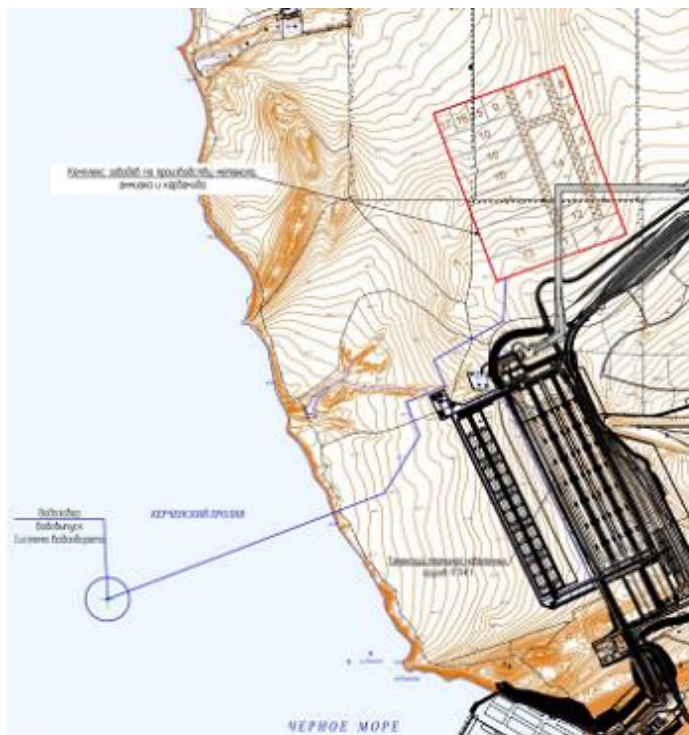
Рис.1. Расположение участка намечаемого строительства, водозабора и водовыпуска относительно действующего угольного терминала.
